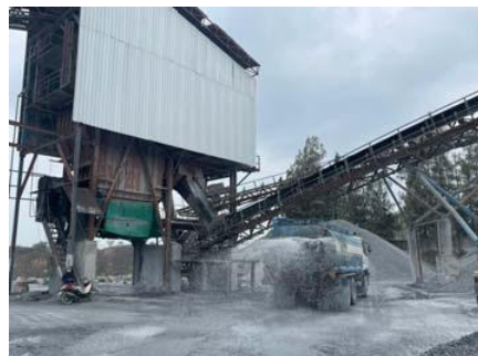
รูปที่ 2-8: การฉีดพรมน้ำบริเวณโรงโม่หินของโครงการ
